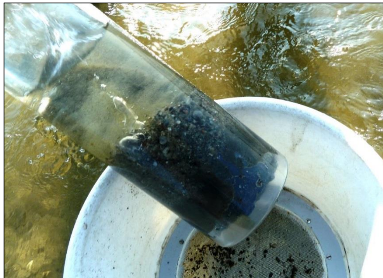
Abbildung 3: Stechrohr "Steffi" mit Epifaunaprobe. Mit dem abgebildeten Handsieb wird die Probe vor Ort gewaschen und von übrigem Material (> 1 mm) getrennt.
